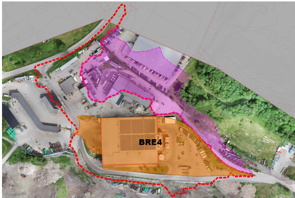
Figur 14 Avrenningsfeltet er markert med rødt, BRE4 markert med oransje skravur og delavrenningsfelt D som ledes vekk fra BRE4 markert med rosa skravur
