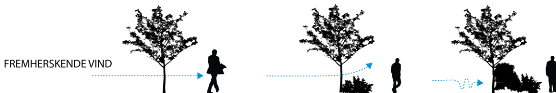
Figur 5-6 En oppstammet trekke kan slippe inn vind under kronen. Det bør derfor etableres et lavere vegetasjons-sjikt under.
