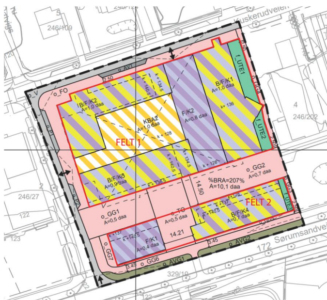
Illustrasjon 27. Oppriss av feltinndeling som utgangspunkt for utregning av feltvis BRA utnyttelse.
