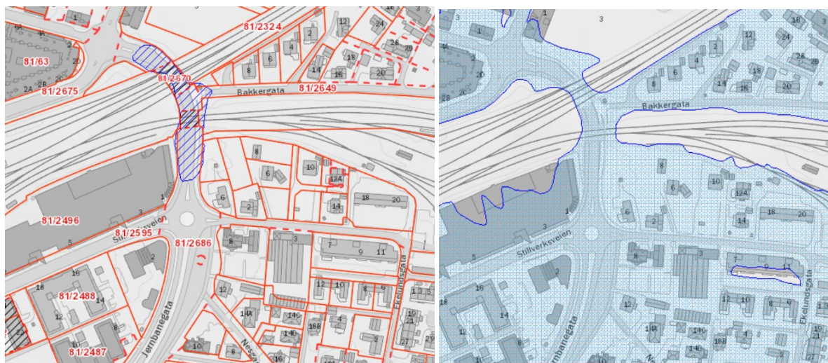
Figur 30 Temakart fra kommunens karttjeneste. På kartet til venstre er 200 års flom markert med blå skraver, og på kartet til høyre er 1000 års flom markert i blått.
